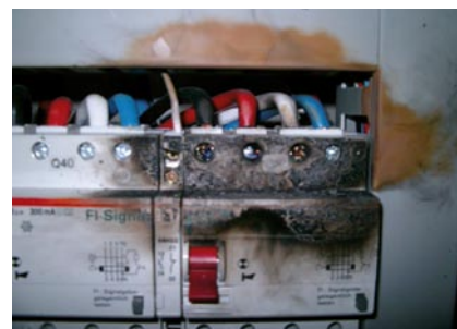
Figure 3 Court-circuit de 3,6 kA provoqué lors d'une mesure. L'équipement de protection individuel était disponible, mais pas porté, ce qui a provoqué de graves brûlures aux mains.
